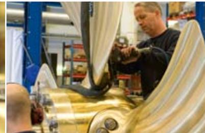
Después de 1 h se realiza una prueba en la cual la hélice soportará 70 bares de presión de aceite.
