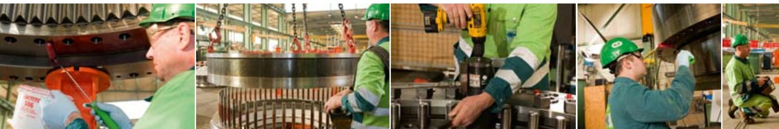
El mecanismo de transmisión se monta con, al menos, cuatro grandes ruedas dentadas unidas y empernadas. Con un rodillo se aplica Loctite® 586 cubriendo la totalidad de la brida y con ello la capacidad de transmisión de par aumenta en torno a 2,5 veces.
