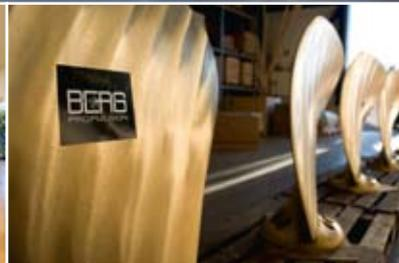
Palas de hélice listas para el montaje.
