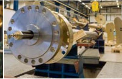
El sistema hidráulico se encaja en el eje.
