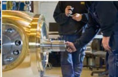
Fijación del tapón externo del eje con Loctite® 243.
