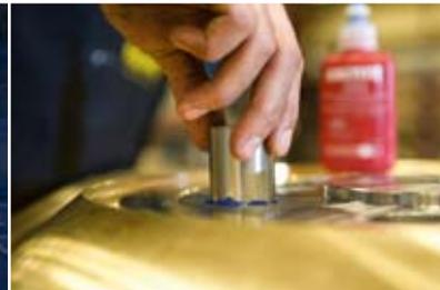
Un pasador controla la hélice. Se fija con Loctite® 243.
