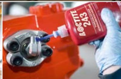
Este rácor roscado tiene que soportar una presión de aceite de hasta 350 bares.
