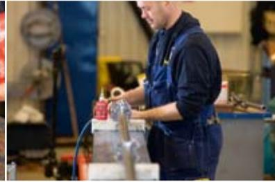
Montaje de los tramos de tubería. Fijación con Loctite® 243.
